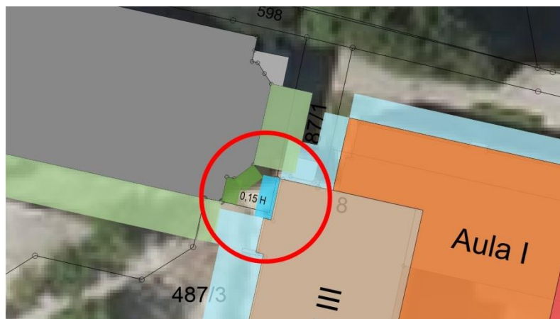
Abb. 12 Engstelle zwischen Loisachhalle und Schulgebäude mit einer Verkürzung der Abstandsfläche von 0,15 H über eine Breite von max. 5 m.
